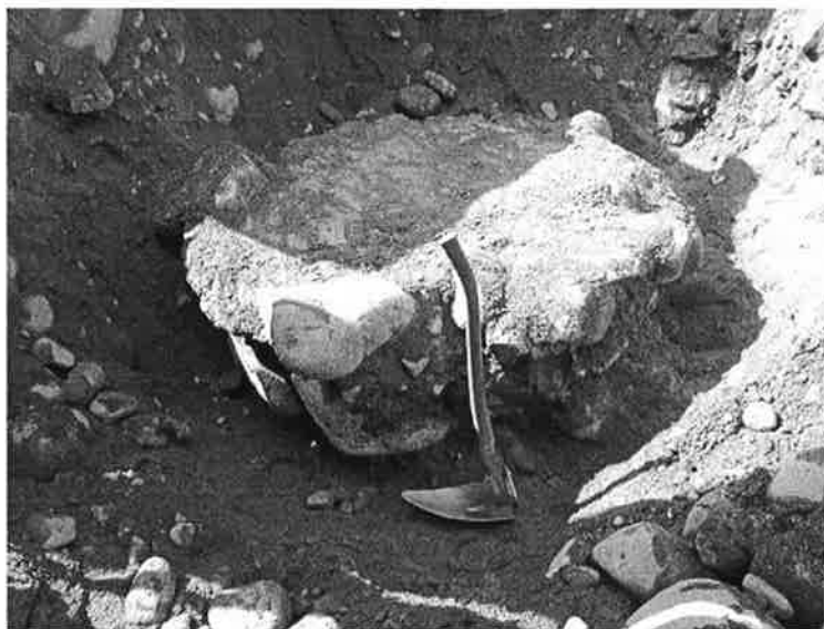
Bild 6. Framschaktad jetpelare, testpelare no. 1, \phi 900 mm
